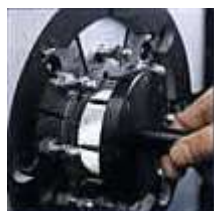
SOSTITUZIONE DELLE MATRICI TRAMITE UNA FORCELLA
